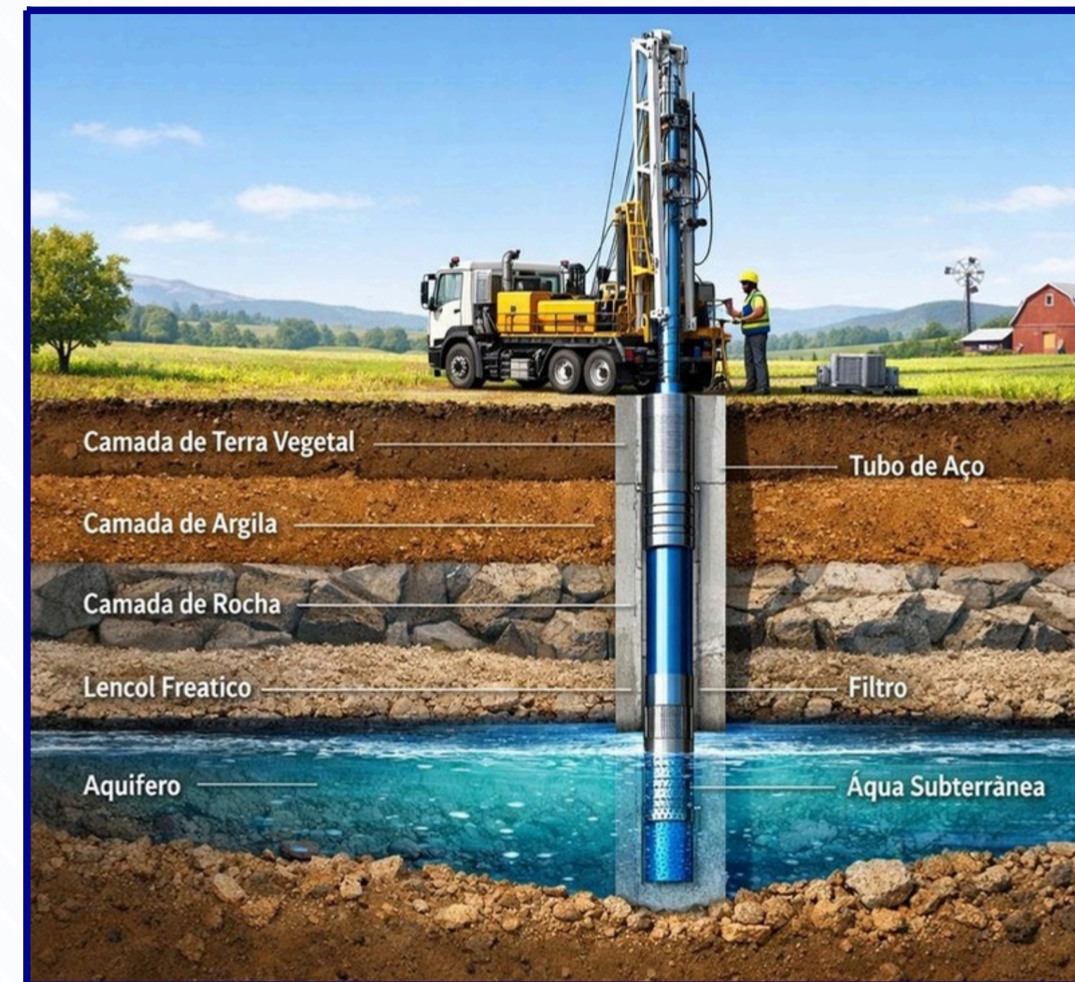
Ilustração técnica do processo de perfuração de um poço artesiano
