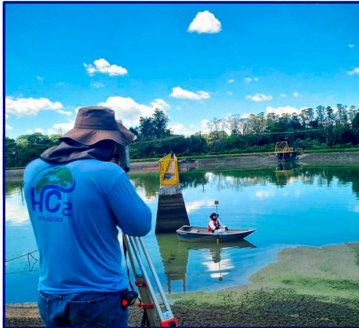
Operação em campo: serviços topo-batimétricos
