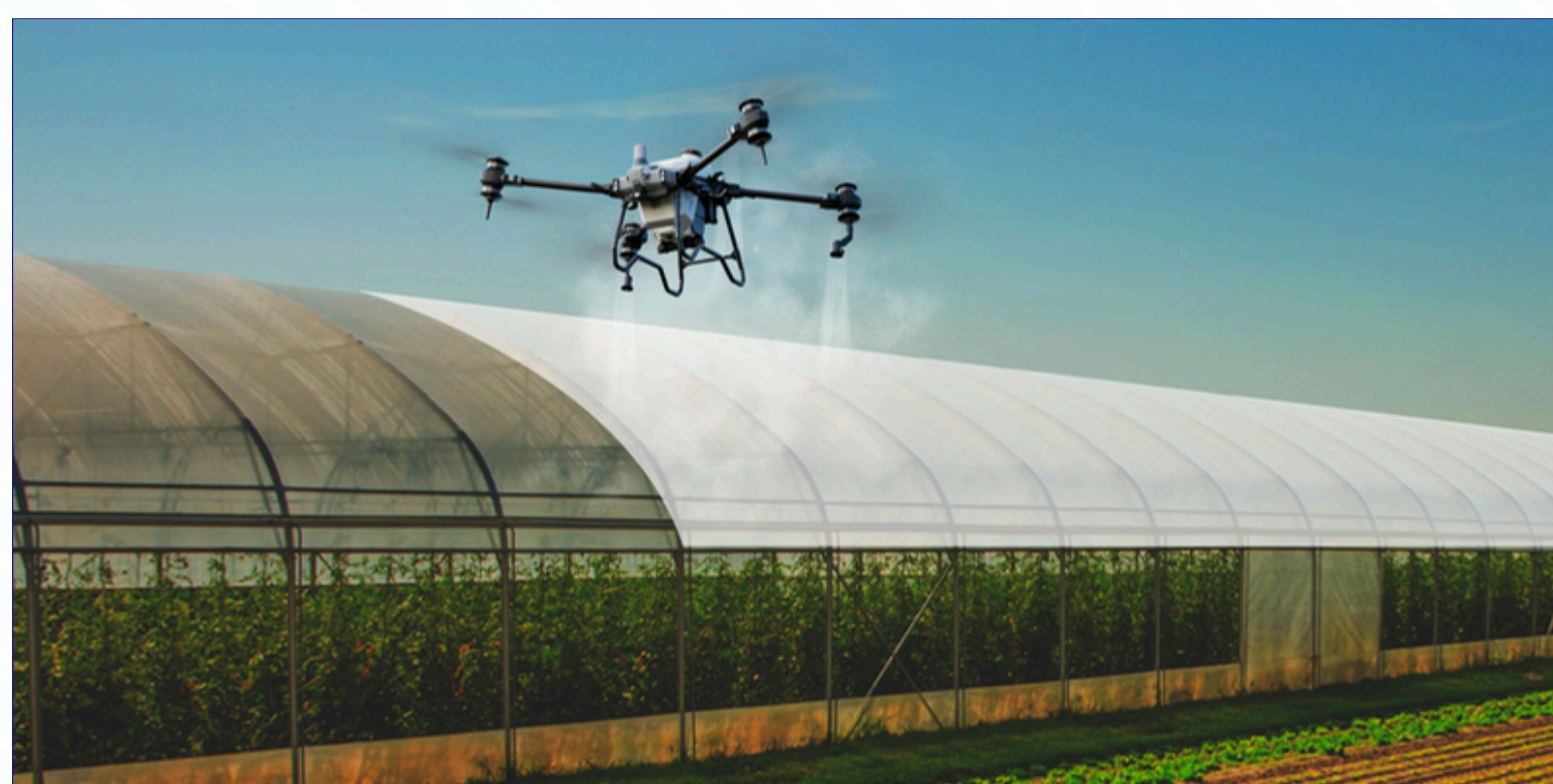
Pintura de estufa a partir do uso de drone agrícola - Holambra/SP
