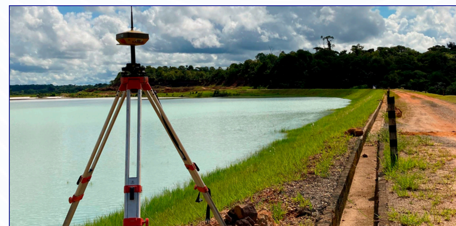
Ocupação e rastreo de base GNSS em área de barragem - Almeirim/PA
